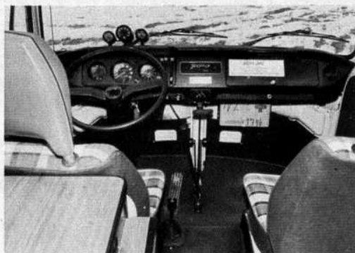
Zwischen den beiden Sitzen liegt der Schaltknüppel, mit dem man den Vierradantrieb auch während der Fahrt zuschalten kann
