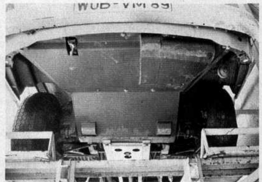
Sehr massiv ist der Unterbodenschutz des Allradbusses – die Abdeckplatte unter der Vorderachse schützt das zweite Differential
